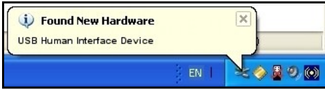
Fig. 15 – Ejemplo de una burbuja informativa relativa a la identificación de un nuevo dispositivo (Windows XP)
