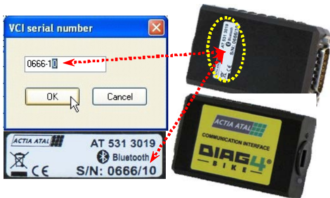
Fig. 5 – Ventana de diálogo para introducir el número de serie de la interfaz de comunicación y su posición en la placa
